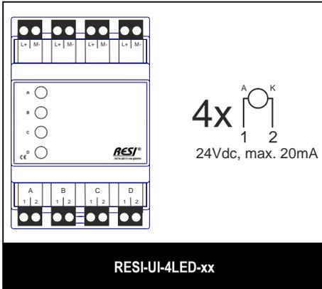
Unsere Meldemodule bieten vier LEDs zur Darstellung von Anlagenzuständen oder Störungen im Bereich HKLS, Licht, Elektro, Sicherheit.
