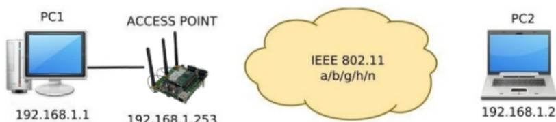
Paramétrez la connexion sans fil de PC2 selon les paramètres d'usine fixés dans le point d'accès (802.11g+n, canal 6, SSID « acksys », sans sécurité).
