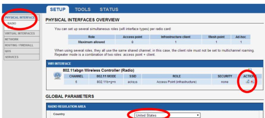
Vous pouvez sélectionner l'interface radio afin de configurer les paramètres Wi-Fi (Vous pouvez également sélectionner l'interface Ethernet ou la partie "Services" afin de les configurer)
