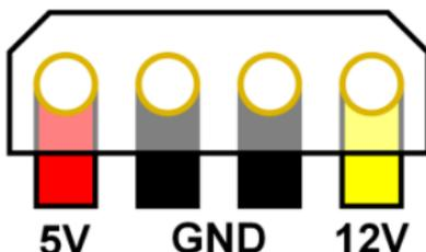
Le produit peut être alimenté avec une alimentation 12V (1A mini) de type ATX.
