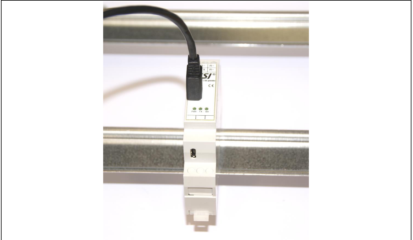
Abbildung: Eingang des USB Kabels durch den 45mm Maskenausschnitt nach vorne, um externe USB Geräte außerhalb des Schaltschranks anzuschließen
